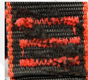
Шов, подвергшийся тепловому воздействию
