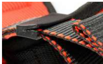
Повреждение пластиковой шлевки фиксации ленты
