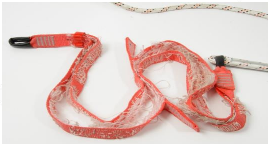
Строп с амортизатором после остановки падения
