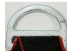
Страховочная точка на привязи с трещиной
